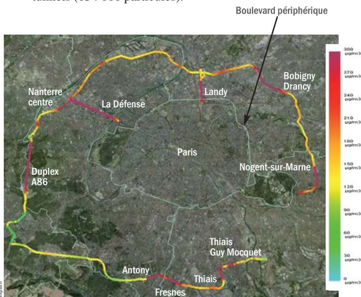
Concentrations de dioxyde d'azote mesurées le 20 mai 2010 lors de mesures en véhicule sur le tour de l'A86
