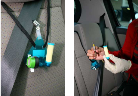
Le dispositif de mesure utilisé permet de piéger chimiquement le polluant voulu.
