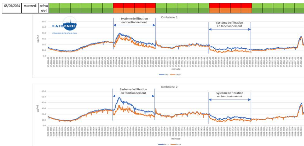
Figure 8: concentration en PM 2.5 relevées le 8 mai 2024 sur les deux ombrières. En bleu, niveaux mesurés au-dessus du système de filtration. En orange, niveaux mesurés sous le système de filtration
