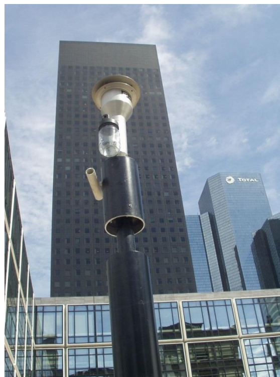
Figure 1 : Station de mesure de la qualité de l'air sur le parvis de la Défense (92)
