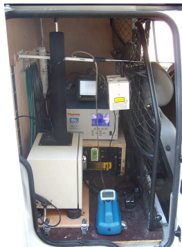
Les appareils de mesure sont reliés à une prise d'air au niveau de la tête de l'automobiliste
