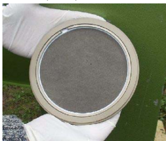
Figure 11 : Dispositif de prélèvement des dioxines dans l'air ambiant
